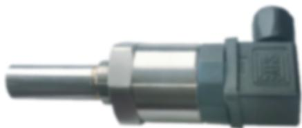
本液位计采用电容测量原理，自带介质补偿电极，通过二段电极差分计算出准确液位。当被测液位大于量程的50%时，液位计自动补偿介电常数变化，以适应测量不同液体。本液位计适合燃油、润滑油等油位的测量，同时也可测量导电类液体。
